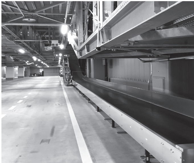
写真上：作業時に頭をぶつけるフレーム 写真左：角が鋭角でタイヤがパンクする可能性がある
