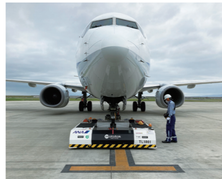
▼航空機の牽引・移動にリモートコントローラで操作可能な電動車両を使用（佐賀空港）
