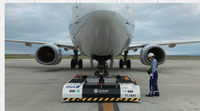
航空機の牽引・移動にリモートコントローラで操作可能な電動車両を使用（佐賀空港）
